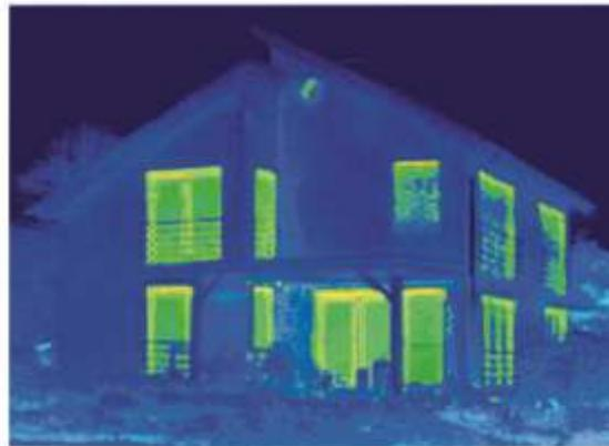
Nach dem sorgfältigen Einbau neuer Fenster aus dem Fenstersystem LivInG beweist die Thermografie den hohen energetischen Nutzen der Investition. Der ursprüngliche Energieverlust wird nahezu vollständig vermieden.
